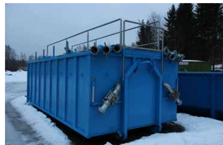
Separointikontti tarvitaan mikäli rakennusvalvonta vaatii vedenpuhdistusta ennen maahan laskua.
