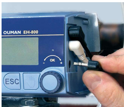
Irrota säätönuppi venttiilistä ja laita asennussarja paikoilleen. Paina EH-800 paikoilleen, kytke anturit ja käyttöjännite pistokeliittimiin, niin laite on käyttövalmis!
