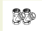
Suodatin 24 - 40 kW: 2 kpl G1 1/4 (sisäkierre), 2 kpl G1 1/2 (sisäkierre) 60 kW: 2 kpl G1 1/4 (sisäkierre), 2 kpl G2 (sisäkierre)
