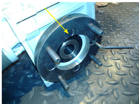
Asenna moottorin sovitustaippa moottoriin neljällä M8x25 uppokantaruuvilla.
